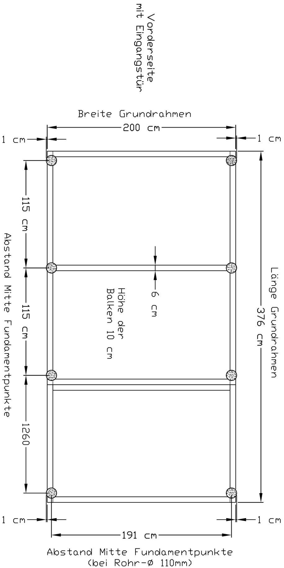
Abstand Mitte Fundamentpunkte 191 cm gilt nur für Rohr- $\varnothing$  110mm.
